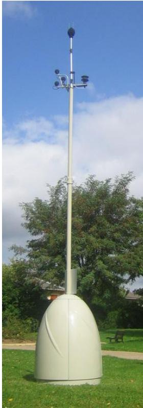
Figure 6 : station de mesure experte implantée au sein d'un sonopode©
